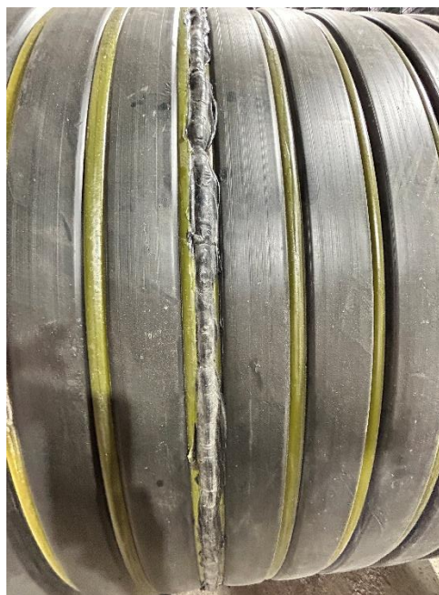
Рисунок 7 – Сварной шов
